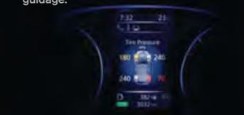
**PRESSION DES PNEUS.** La pression des pneus s'affiche sur l'écran d'information. En cas de détection d'une perte de pression, un signal vous alerte.
