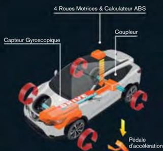
**ALL MODE 4X4-i\*:** Cette transmission utilise des capteurs électroniques qui contrôlent le patinage des roues pour répartir automatiquement le couple jusqu'à 50% sur les roues arrière.
