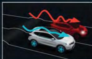
**ACTIVE RIDE CONTROL (CONTRÔLE ACTIF D'ASSIETTE),** permet un comportement routier plus souple. En complément du système d'amortissement, il contrôle et atténue les mouvements de caisse liés aux imperfections de la route.
