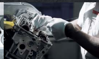
L'ESPACE ENTRE LA CAME et la tête de soupape est ajusté par des ingénieurs expérimentés.
