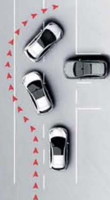
**ABS.** En cas de freinage d'urgence, le système d'antiblocage des freins ABS empêche le blocage des roues pour vous aider à garder le contrôle et la stabilité du véhicule.
