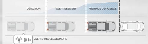
**Freinage d'urgence autonome (AEB).** Un radar monté dans le pare-chocs avant mesure la distance qui sépare votre véhicule du véhicule précédent. S'il détecte un risque de collision, il émet une alerte sonore et visuelle. Si vous ne freinez pas suffisamment, un freinage automatique est appliqué pour éviter l'accident. Le système fonctionne quelle que soit la vitesse et évite les collisions à coup sûr jusqu'à 30 km/h.
