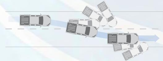
**Contrôle électronique de la trajectoire (ESP).** Le système ESP contrôle la direction, le freinage et la stabilité du véhicule et réduit la puissance du moteur ou applique une pression de freinage sur les roues appropriées si cela est nécessaire pour maintenir votre trajectoire.
