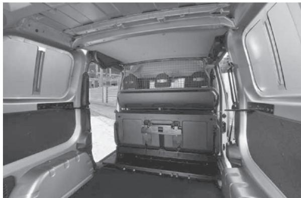
Volume utile avec banquette - cloison grillagée rabattue (en position transport de matériels) de 2,9 m<sup>3</sup>.
