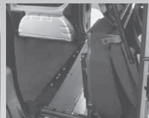
Banquette - cloison grillagée en configuration transport de personnes avec des tissus identiques aux sièges avant.
