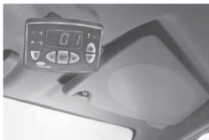
Unité de contrôle de la température de la cellule froid installée dans l'habitacle.
