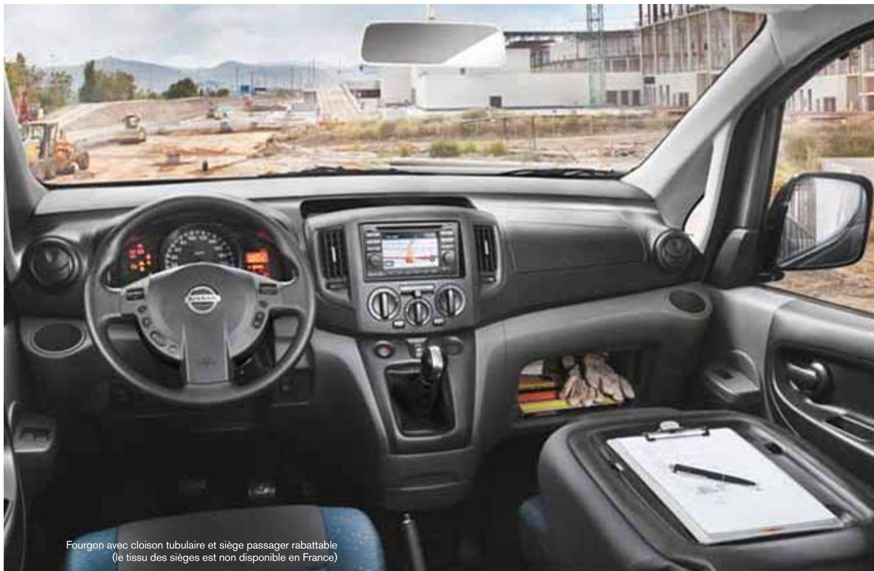
Fourgon avec cloison tubulaire et siège passager rabattable
