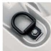
6 crochets d'arrimage fixes au sol pouvant porter jusqu'à 509 kg.
